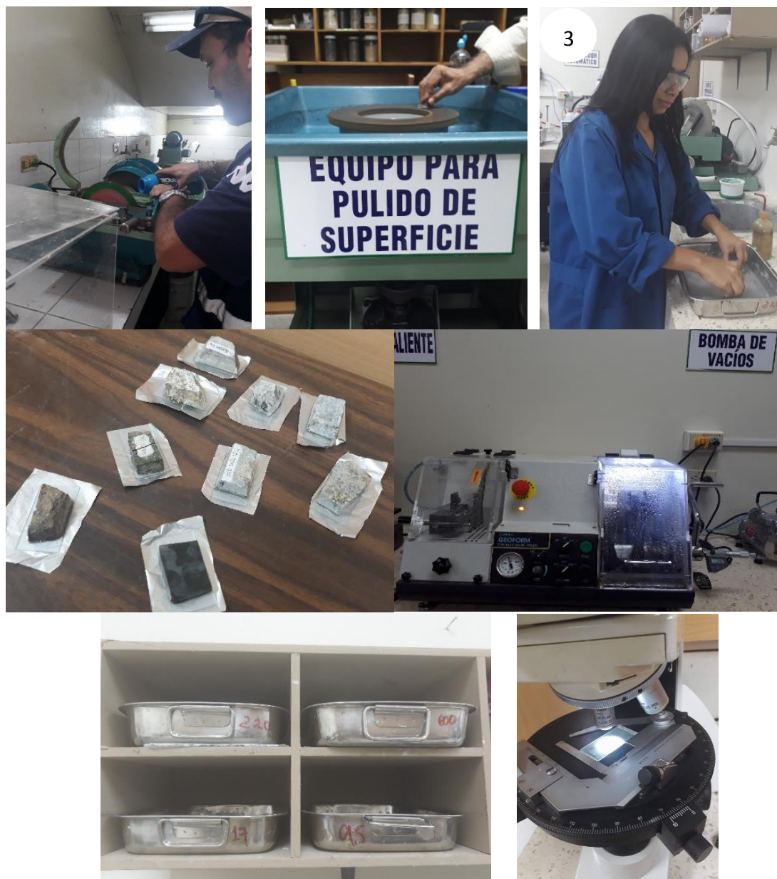
Figura 0.15 Procedimiento para la elaboración de láminas petrográficas.
