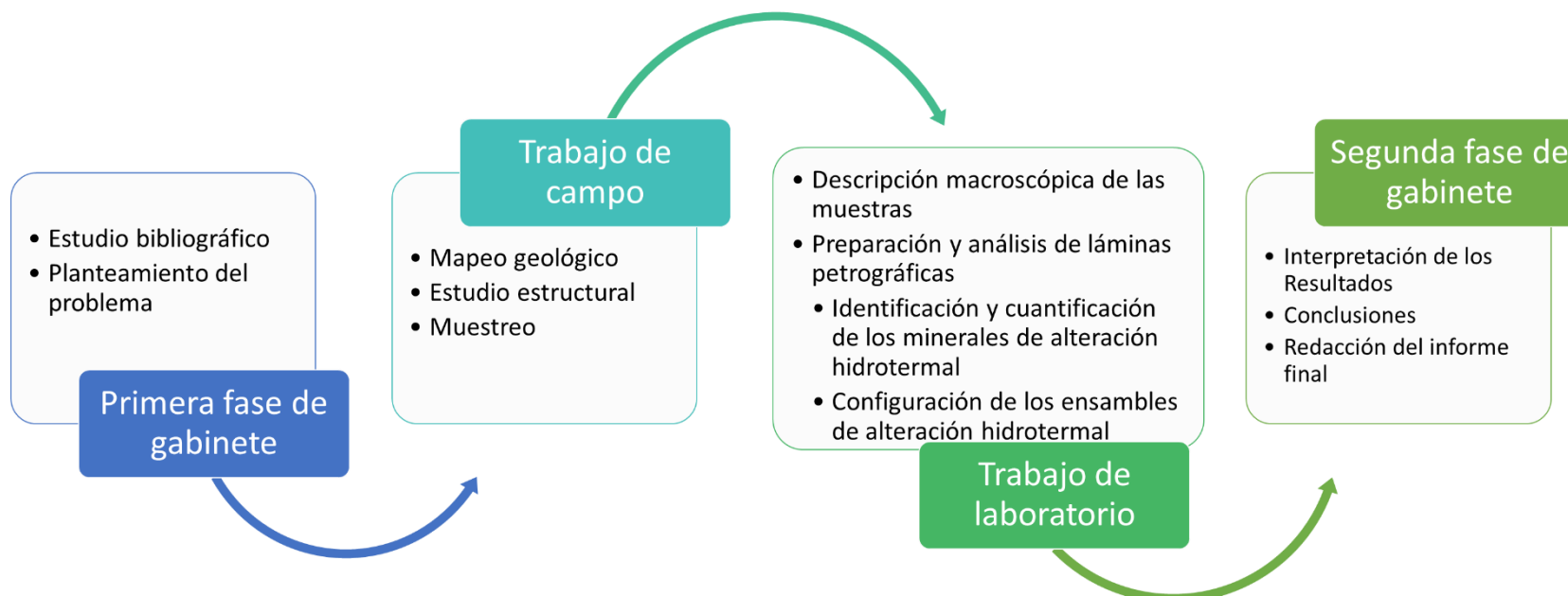
Figura 0.8 Esquema de la metodología de trabajo aplicada para el desarrollo de esta proyecto de materia integradora. Consta de 4 Etapas: 1.Primer Fase de Gabinete, 2.Trabajo de Campo, 3. Trabajo de Laboratorio, 4. Segunda Fase de Gabinete. Fuente: Díaz, M., 2017.
