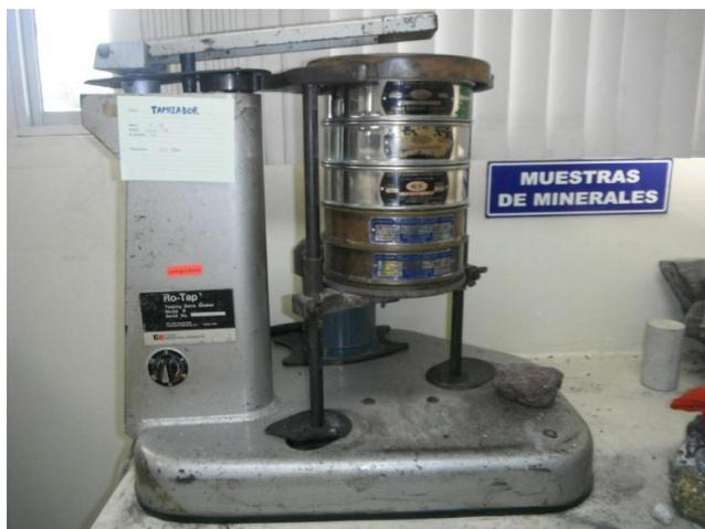
**Figura 5.- Tamizador, laboratorio de mecánica de suelos de la Facultad de Ingenierías de Ciencias de la Tierra FICT-ESPOL.**
