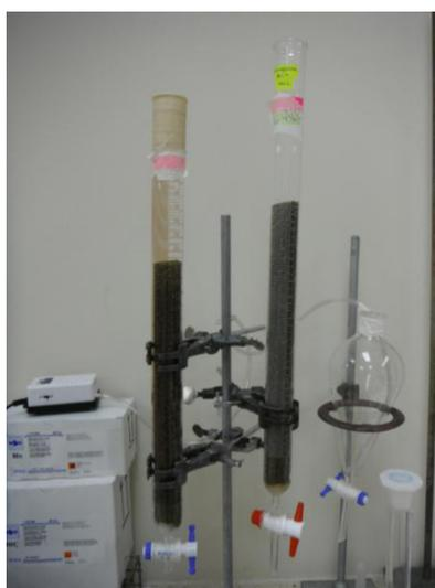
**Figura 6.- Buretas con relleno de Zeolita Clinoptilolita**
