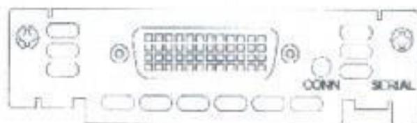
**FIGURA 31. Vista de la Interface WAN del Equipo Cisco 1601**
