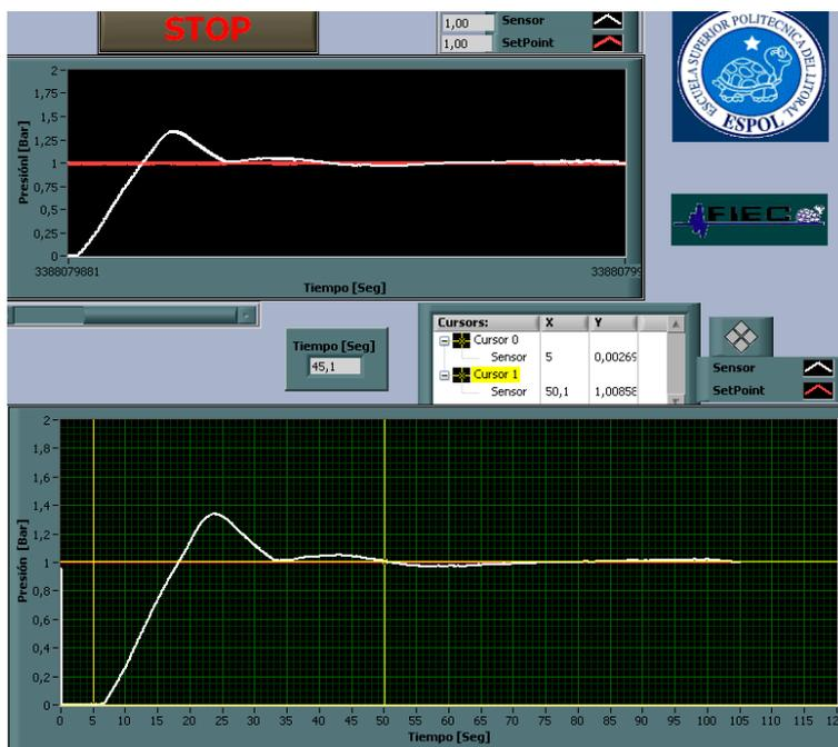
Figura 6.14 PID Presión-Gunt 450.03
