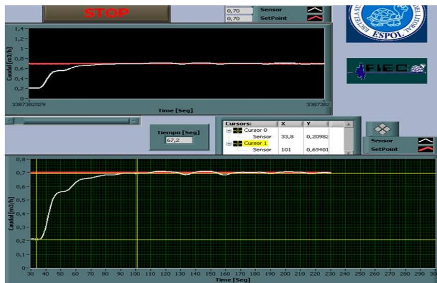
Figura 2.26 Respuesta controlador PID - Gunt RT450.02
