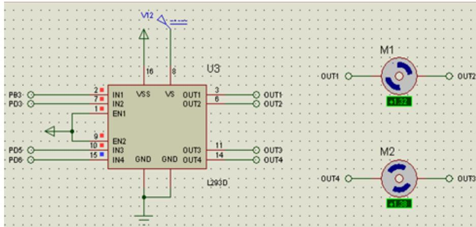
Figura 4.4.- Simulación de Motores DC del Pololu 3pi.
