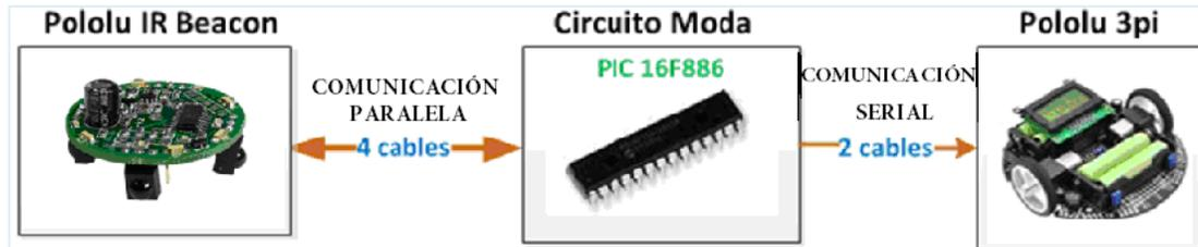
Figura 3.1.- Diseño Preliminar para la interfaz de comunicación.
