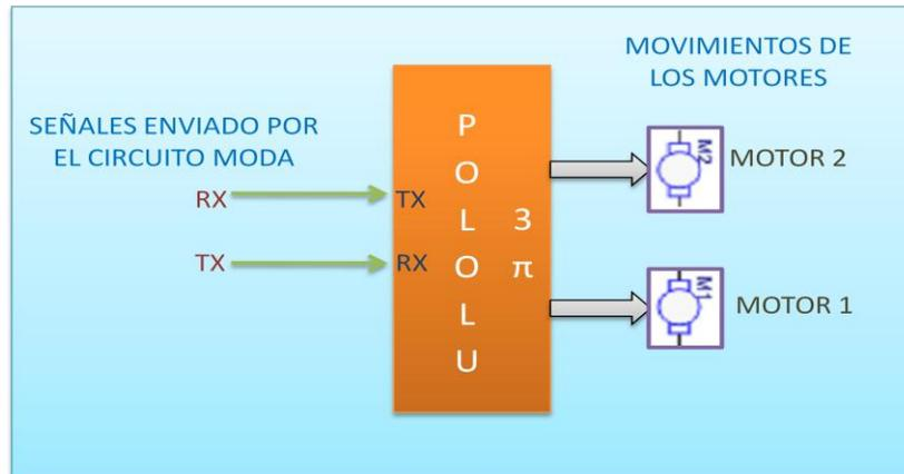
**Figura 3.4.- Diagrama de Bloque del Pololu 3pi.**
