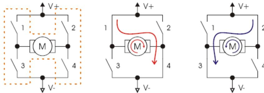
**Figura 2.9.- Diagrama del motor DC con puente H**
