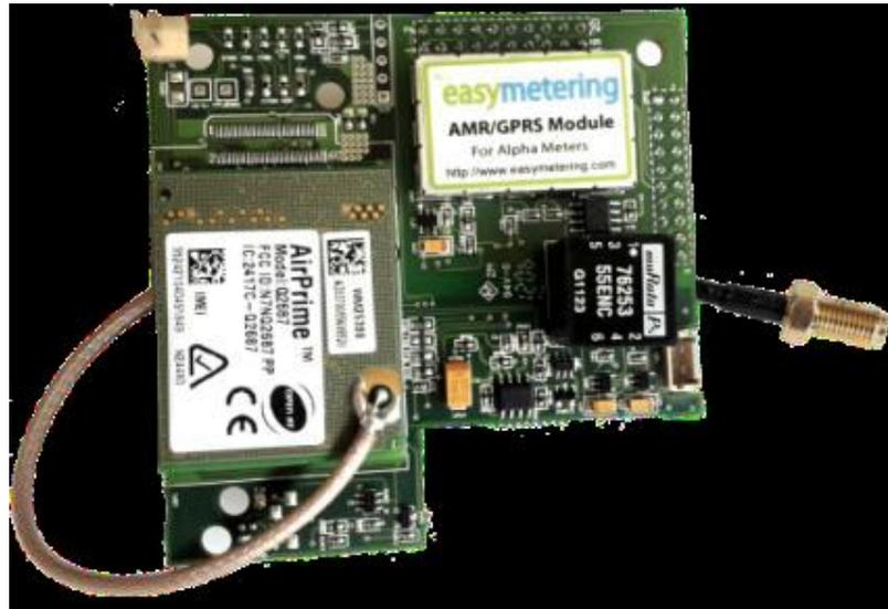
Figura 2.1: Tarjeta de Telemetría para captura de parámetros eléctricos del medidor.
