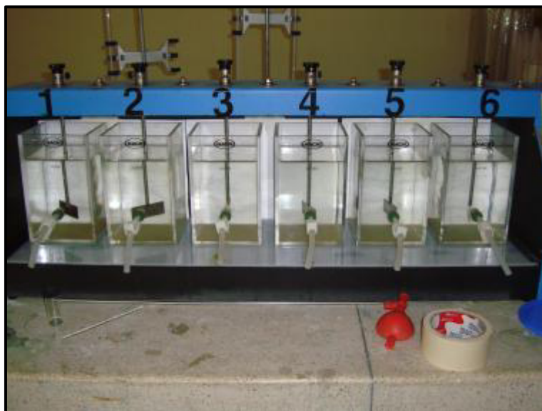
Figura 4-6: Agua clarificada con Floculante químico (RD)
