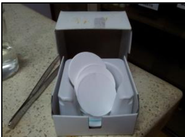
Figura 3-4: Filtros de fibra de vidrio Fuente: Yagual, 2012
