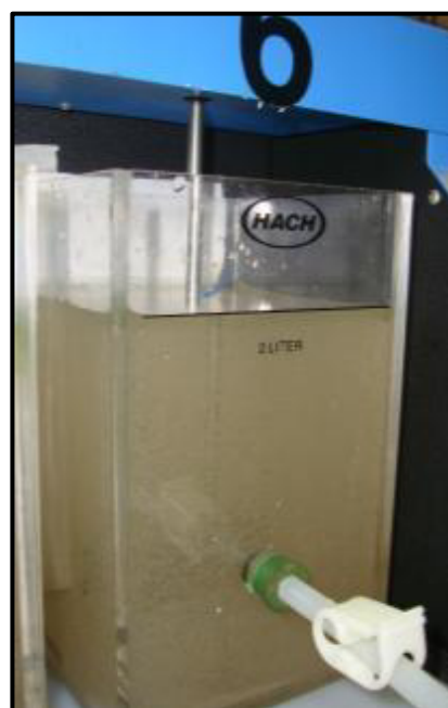
Figura 4-4: Flóculos formados con Praestol (RB) Fuente: Yagual, 2012
