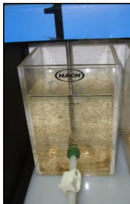
Figura 4-2: Flóculos formados con Praestol (RD) Fuente: Yagual, 2012
