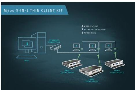
Figura 13. Red LAN de un grupo de trabajo utilizando M300 [10]
