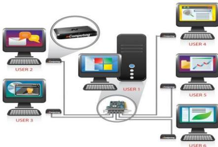
Figura 12. Red LAN de un grupo de trabajo utilizando X550 [9]
