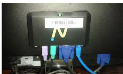
**Figura 3.** Instalación de Ncomputing M300 en un equipo del laboratorio
