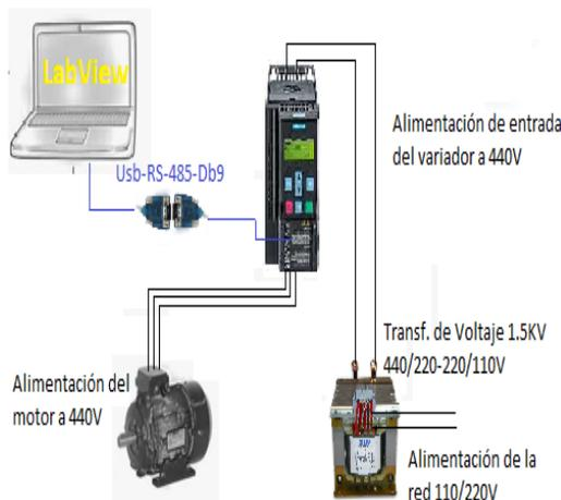
**Figura 5.** Diagrama general de conexiones y equipos usados en el proyecto.
