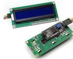
**Figura 2.6** - Pantalla LCD con módulo I2C. [9]
