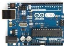
**Figura 2.4** - Tarjeta Arduino Uno. [6]
