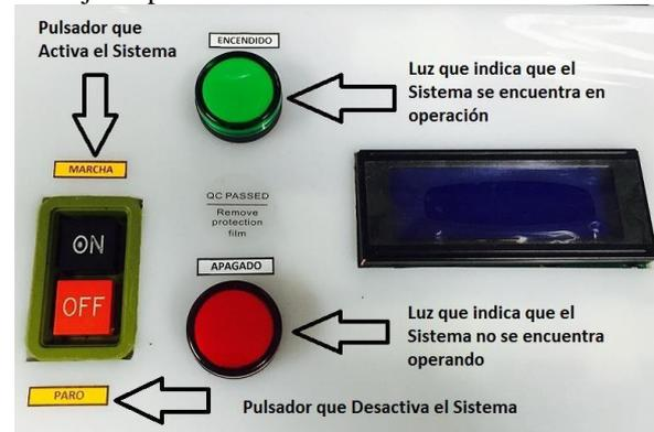
Figura 4.2 - Interruptores para activación/desactivación de los Procesos del Sistema.
