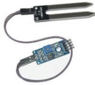
**Figura 2.2-** Sensor de humedad del suelo (fc-28). [3]
