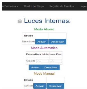
Figura 6. Interfaz para control de luces en modo Ahorro/automático/manual.
