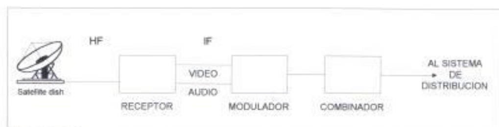
FIG. 5.2.2.2 RECEPCION DE SEÑALES DE TELEVISION VIA SATELITE
