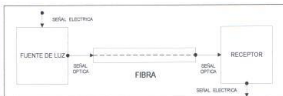
FIGURA 4.1.3.1 ENLACE BASICO DE FIBRA OPTICA
