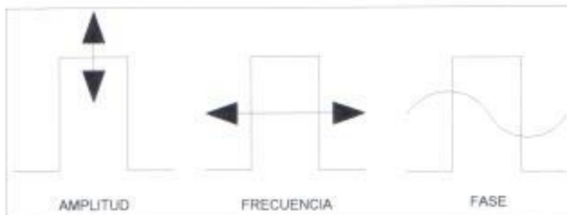
FIG. 1.3.2.4 TIPOS BASICOS DE MODULACION
