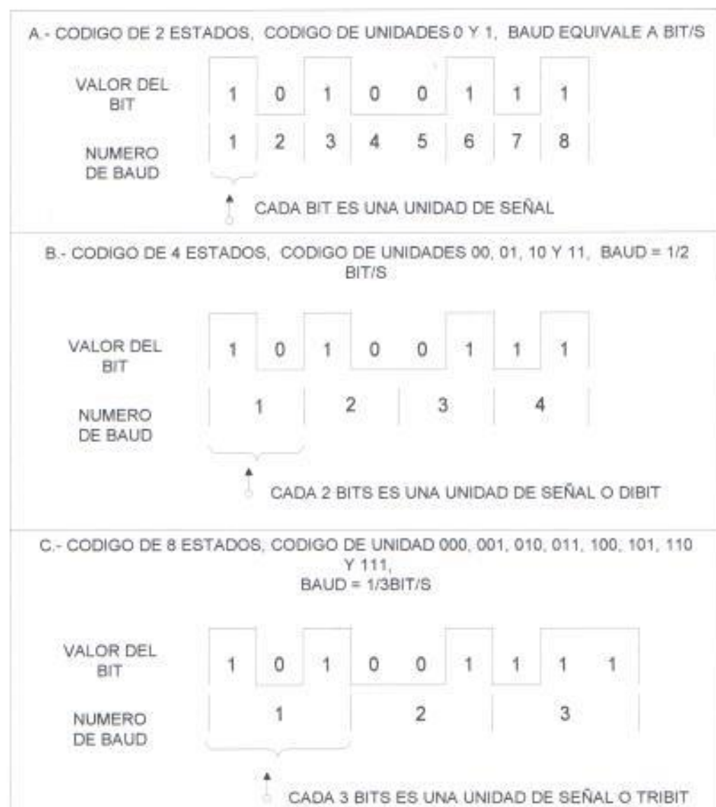
FIG. 1.2.1.2 CODIGOS DE TRANSMISION
