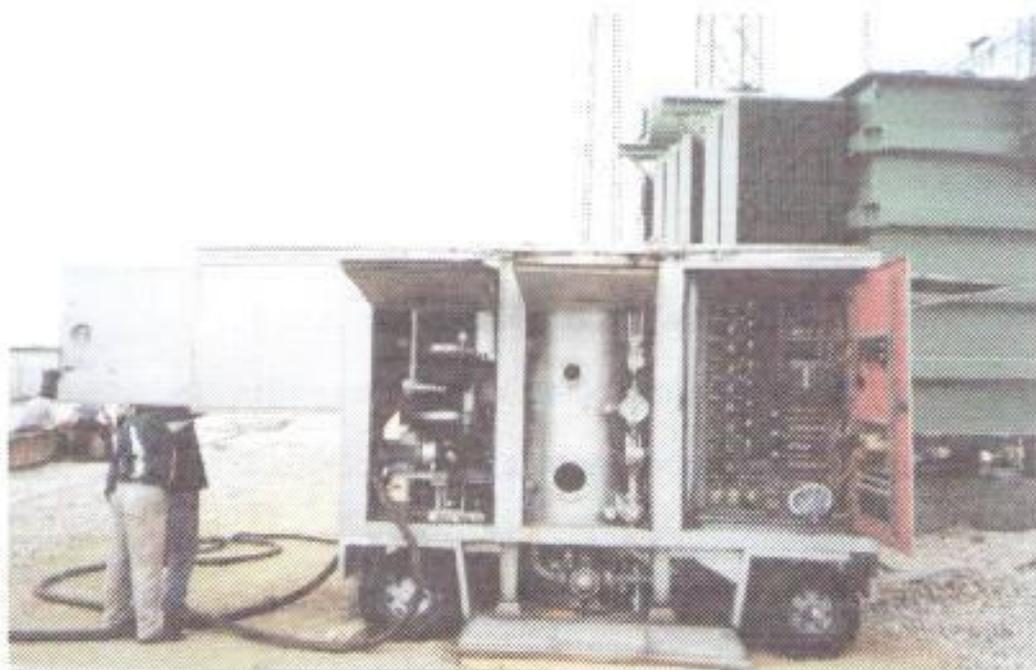
FIG. 5.18 Máquina de tratamiento de aceite 5000 litros/hora
