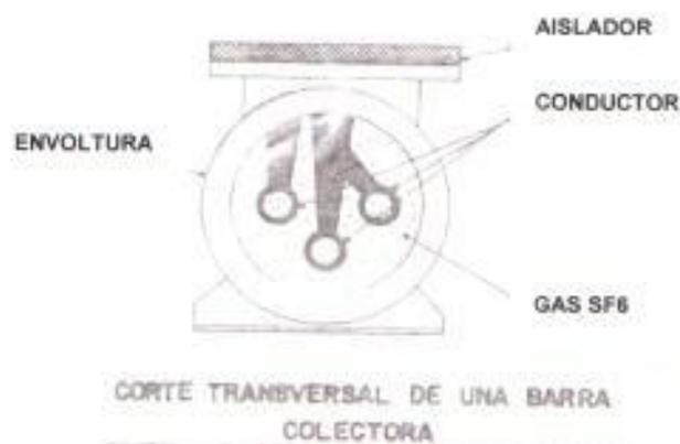
FIG. 4.13A Construcción interna de una barra colectora
