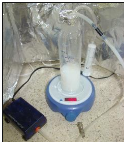
Figura 3.7 Reactor batch con agitador magnético y equipo de aireación Fuente: Los autores
