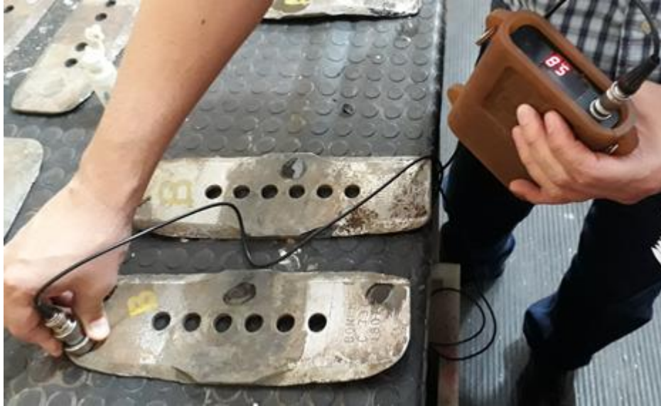
Figura 2. 5. Medición de espesores realizada a cuchillas.
