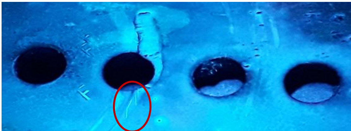
Figura 3. 6. Fisura alrededor de la zona de sujeción de la cuchilla
