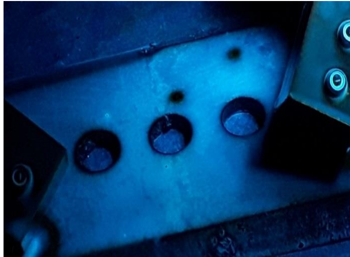
Figura 2. 4. Ensayo de Partículas Magnéticas realizada a cuchillas.
