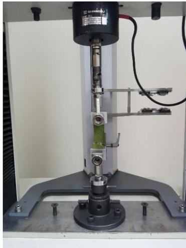
Figura 2.1. Prensa Universal Shimadzu 10kN
