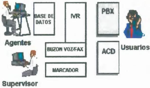
**Figura 2.5:** Integrador Computador – Teléfono
