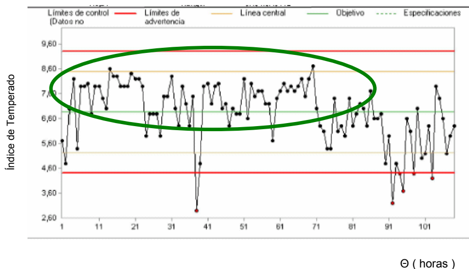
FIG. 3.4.1.1 GRÁFICA DE CONTROL SOBRE EL ÍNDICE DE TEMPERADO EN EL MES DE JULIO
