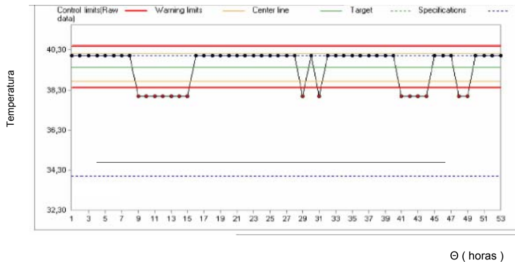
FIG. 3.4.1.9 GRÁFICA DE CONTROL SOBRE LA ENTRADA DE AGUA DEL SECTOR 3
