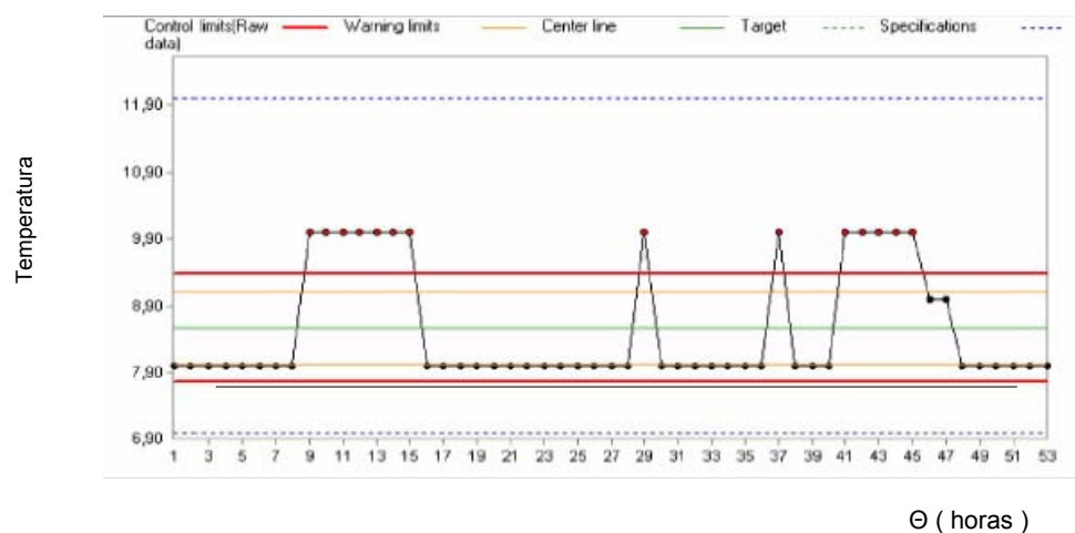
FIG. 3.4.1.6 GRÁFICA DE CONTROL SOBRE LA ENTRADA DE .AGUA DEL SECTOR 2
