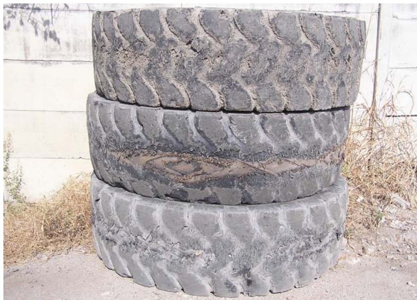
FIGURA 1.11 DESGASTE ACCELERADO EN LA BANDA DE RODADURA DE LOS NEUMÁTICOS DELANTEROS DE LAS CARGADORAS
