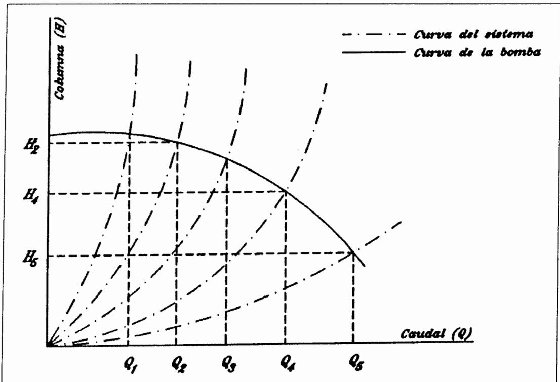
Para un sistema específico, la curva del sistema obedece a la forma algebraica:
