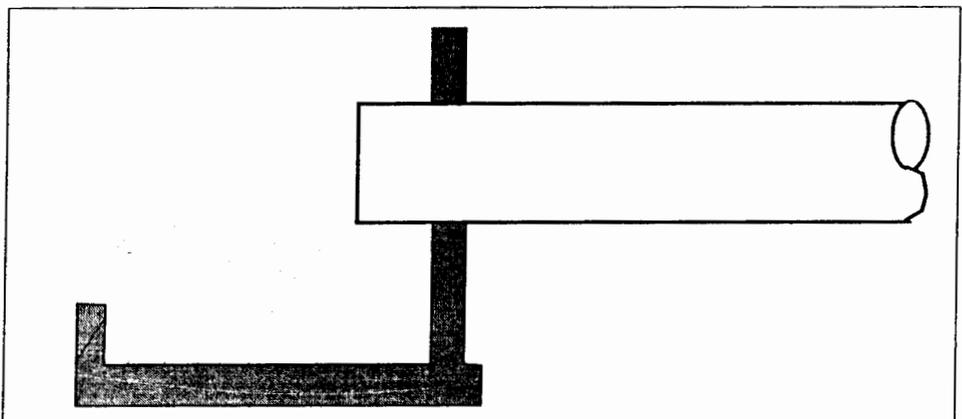
Utilizar estructuras de hormigón que permitan "romper" el chorro de agua.
