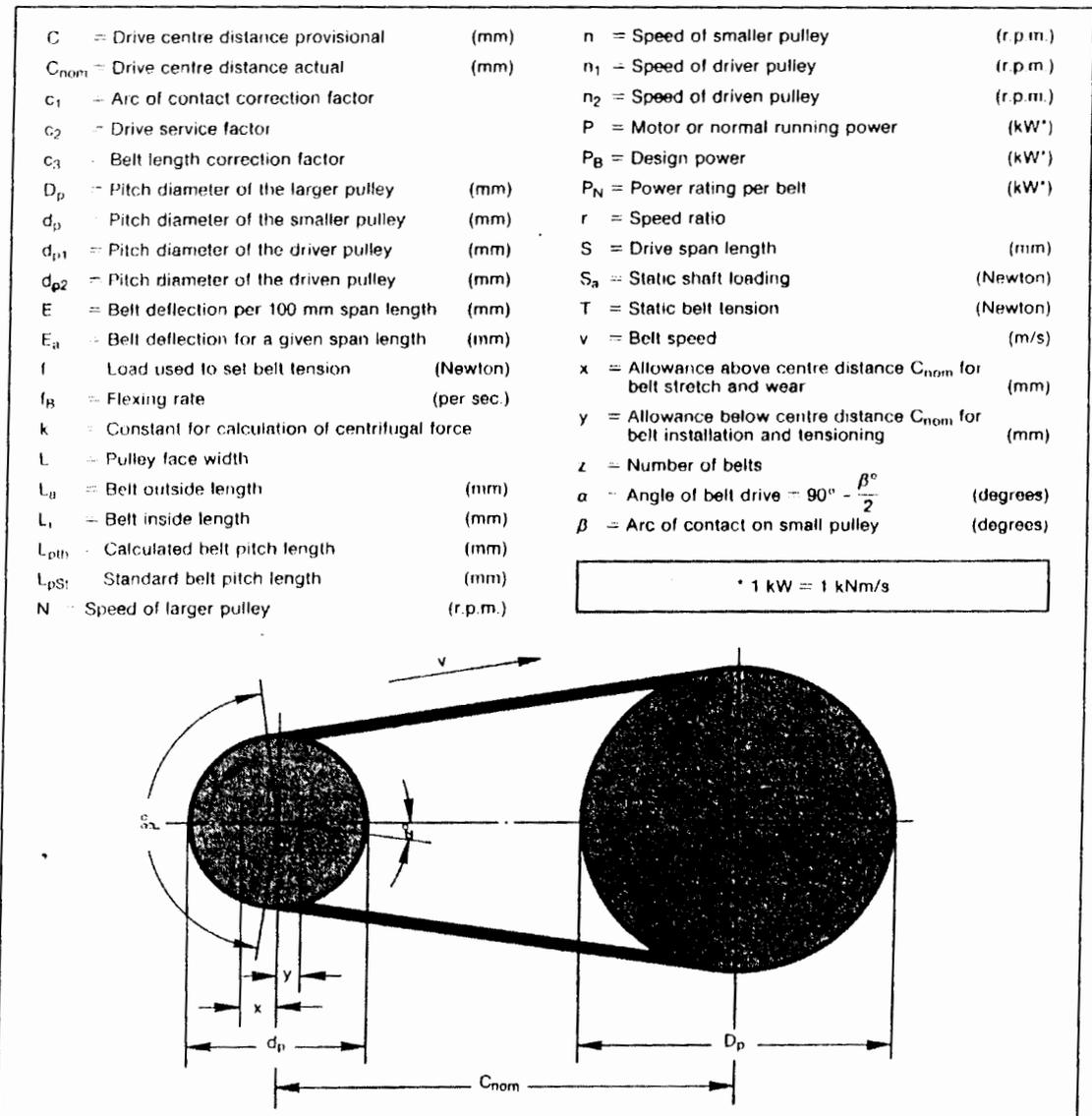
La selección de las bandas se puede hacer en base a la aplicación de ecuaciones o utilizando las tablas suministradas por la American Leather Belting Association y los catálogos suministrados por los diferentes fabricantes de correas. El procedimiento a seguir se detalla a continuación, para el cual es necesario tomar en consideración la nomenclatura indicada en la gráfico 18.
