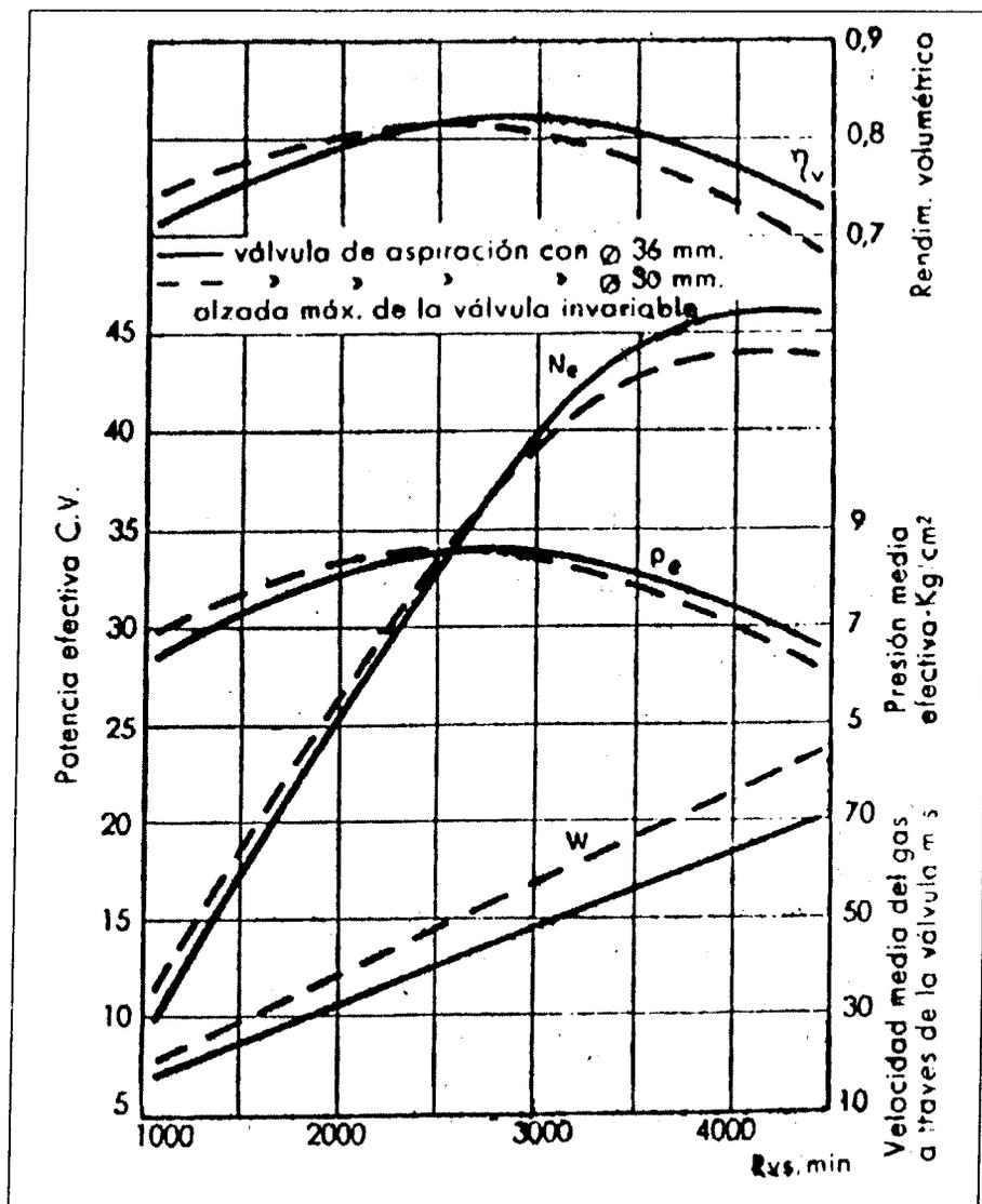
La razón entre la potencia efectiva y la indicada es el rendimiento mecánico del motor.
