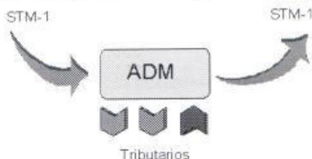
Figura 1.20.- Configuración Multiplexor ADM
