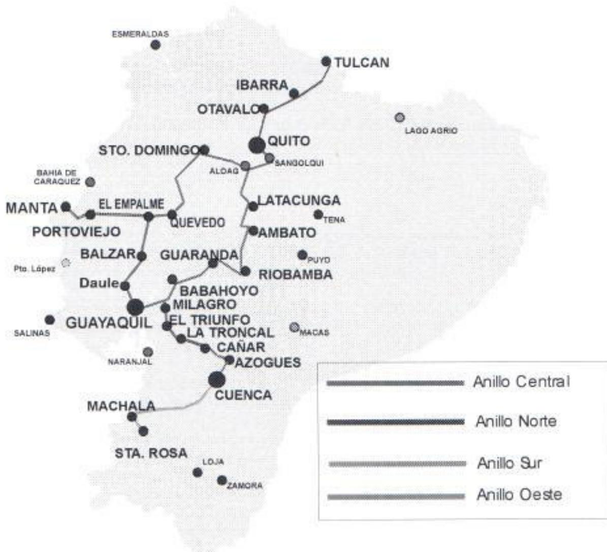
**Figura 4.7.- Representación global anillos red de banda ancha.**
