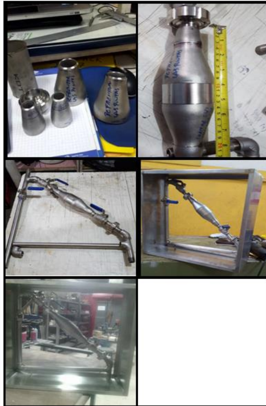
Figura 3.9 Construcción de sistema de inyección
