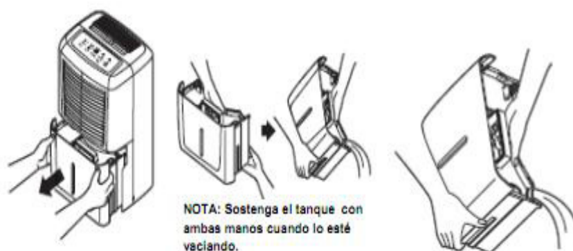
Figura 3.23: Vaciado del tanque del deshumidificador
