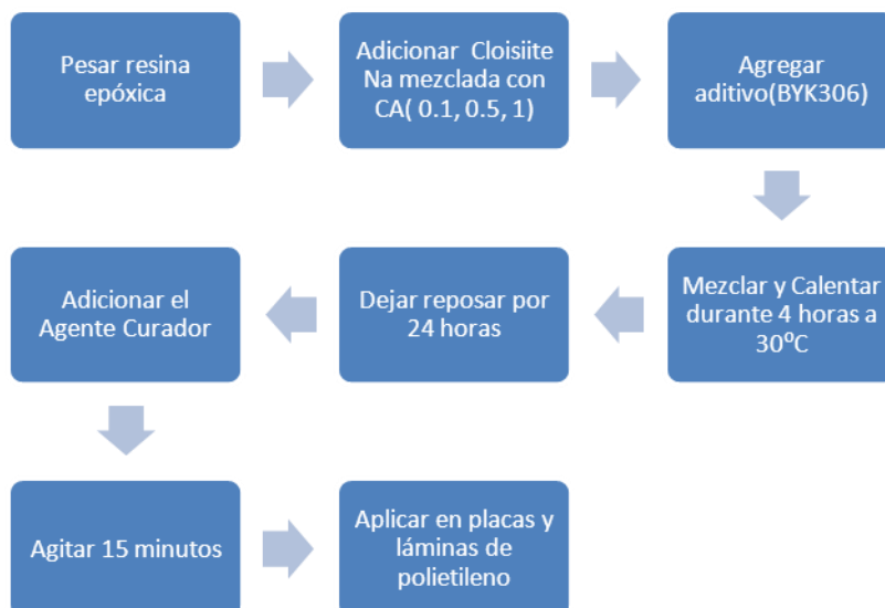
Figura 3.62: Proceso de preparación de compuestos # 7, 8 y 9 de mezclas con Cloisite Na
