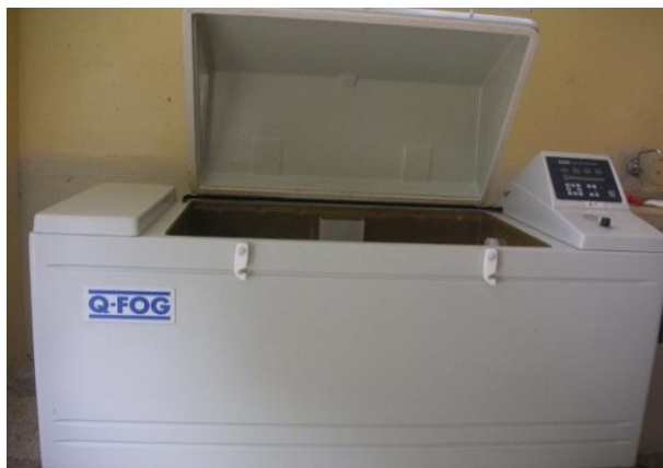
Figura 3.40: Cámara de niebla salina Fuente: Burgos O., Chávez M., Vera G.
