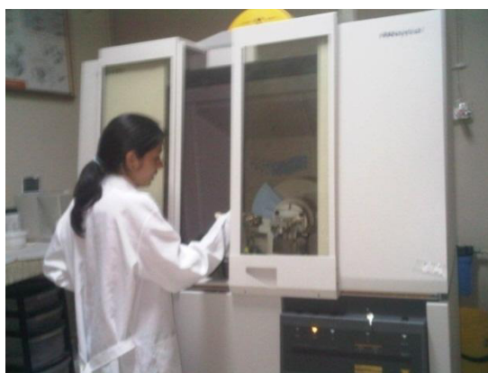
Figura 3.67: Análisis de Difractometría de Rayos X Fuente: Burgos O., Chávez M., Vera G.
