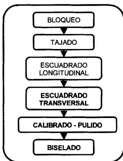
Figura # 1.1 Diagrama de proceso para la obtención de las plaquetas
