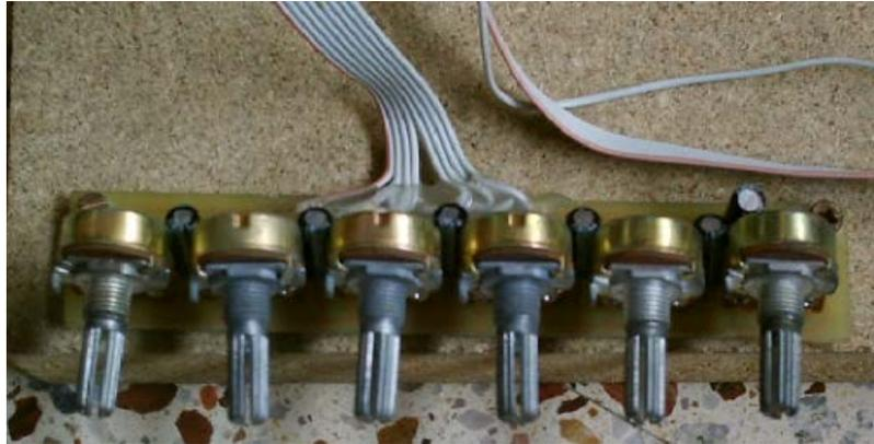
**Fig. 4.21** Fotografía de la Tarjeta de las Entradas
