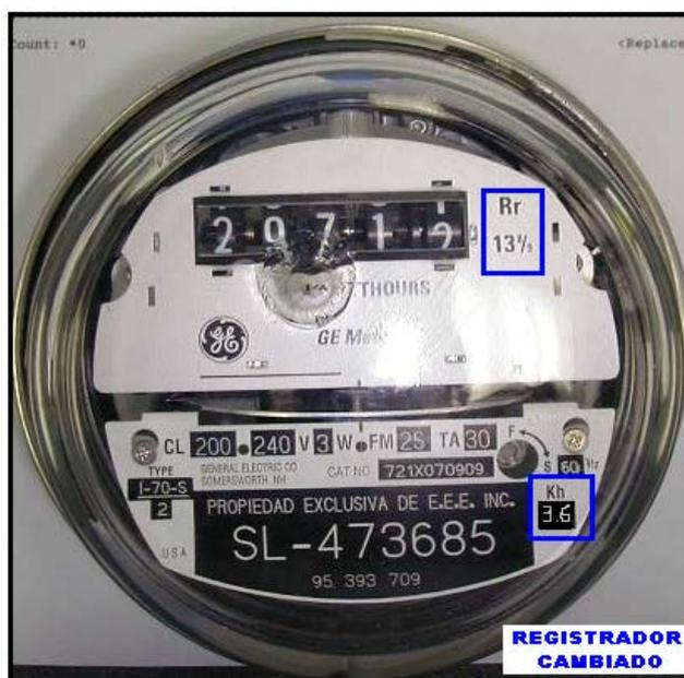
**FIGURA 3.3: MEDIDOR CON REGISTRADOR DE OTRAS CARACTERISTICAS.**
