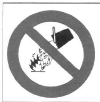
Prohibido usar agua como Extinguidor de fuego
