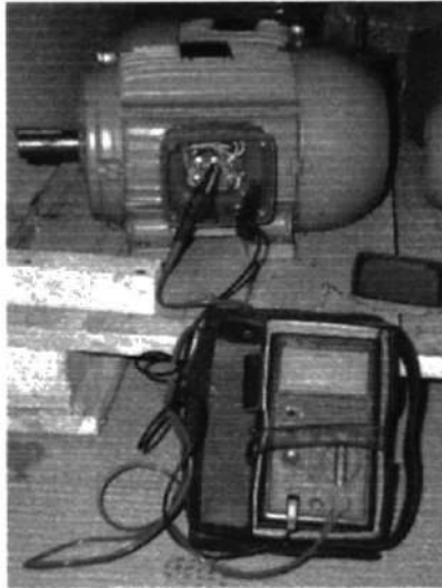
FIGURA 5.20. Medición de la resistencia de aislamiento.
