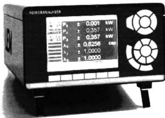
FIGURA 5.14. Analizador de potencia.
