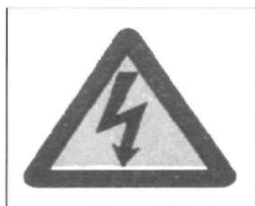
Cuidado, peligro de shock eléctrico. Tensión (voltaje) peligroso
