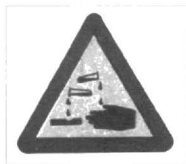
Cuidado peligro de agentes Corrosivos
