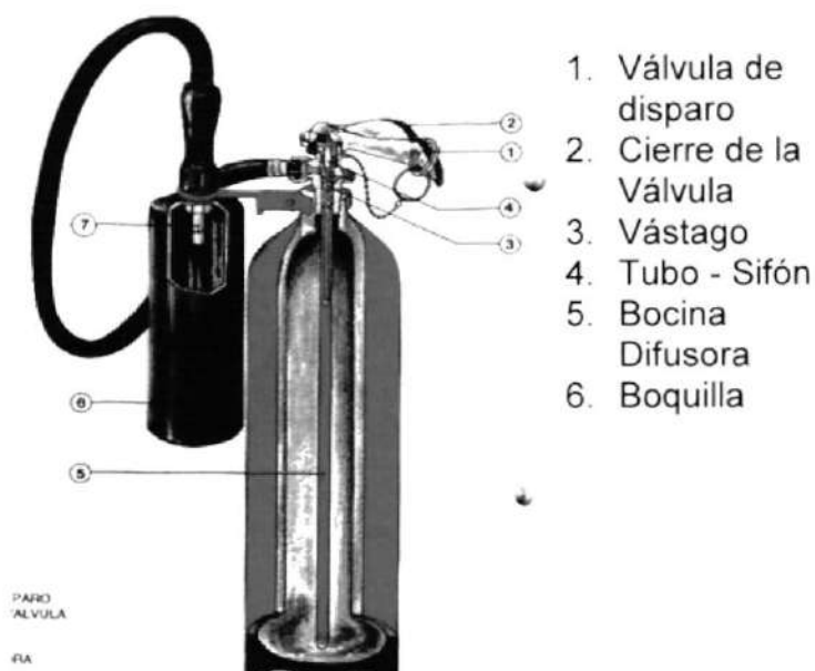
Figura B-9. Extintores de CO 2 .
