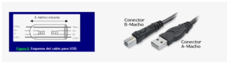
Figura 28.- Esquema del cable para la comunicación USB
