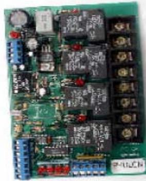
FIGURA 3.56 CONTROLADOR DE RELAYS PHOLON V1
