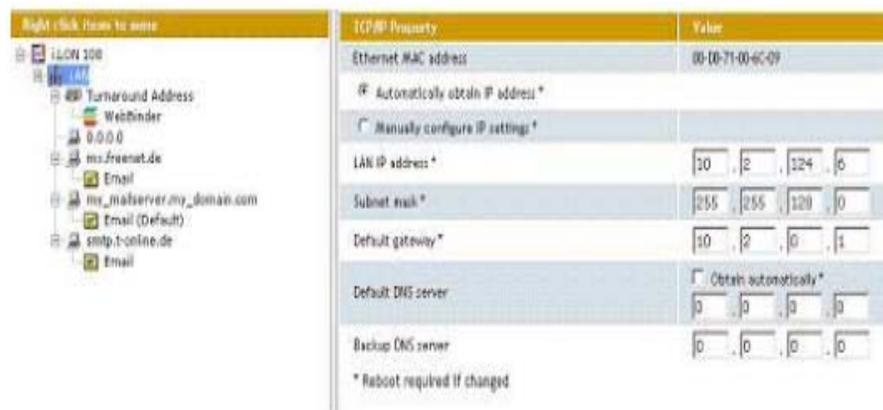
FIGURA 3.105 CONFIGURACION DE PARAMETROS IP DE SERVIDOR Ilon 100
