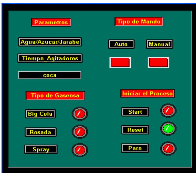
**Figura 2.11** Ventana para la ejecución del proceso.
