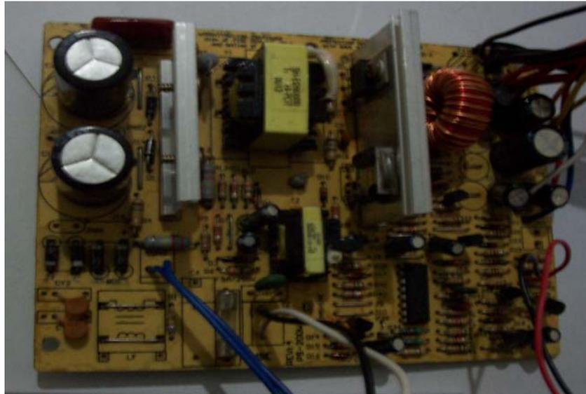
**Figura 5.37** Vista superior de la fuente de conmutación.
