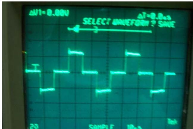
**Figura 5.33** Voltaje en el secundario del transformador entre los pines 5 y 6.
