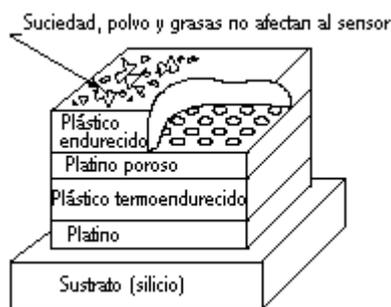
**Figura 1.19.- Sensor de Humedad tipo Capacitivo**
