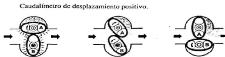
**Figura 1.17.- Sensor de Flujo tipo Desplazamiento Positivo**
