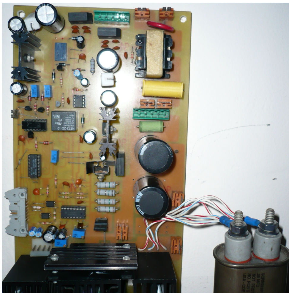
Figura C.6 Foto frontal del Circuito de Potencia.
