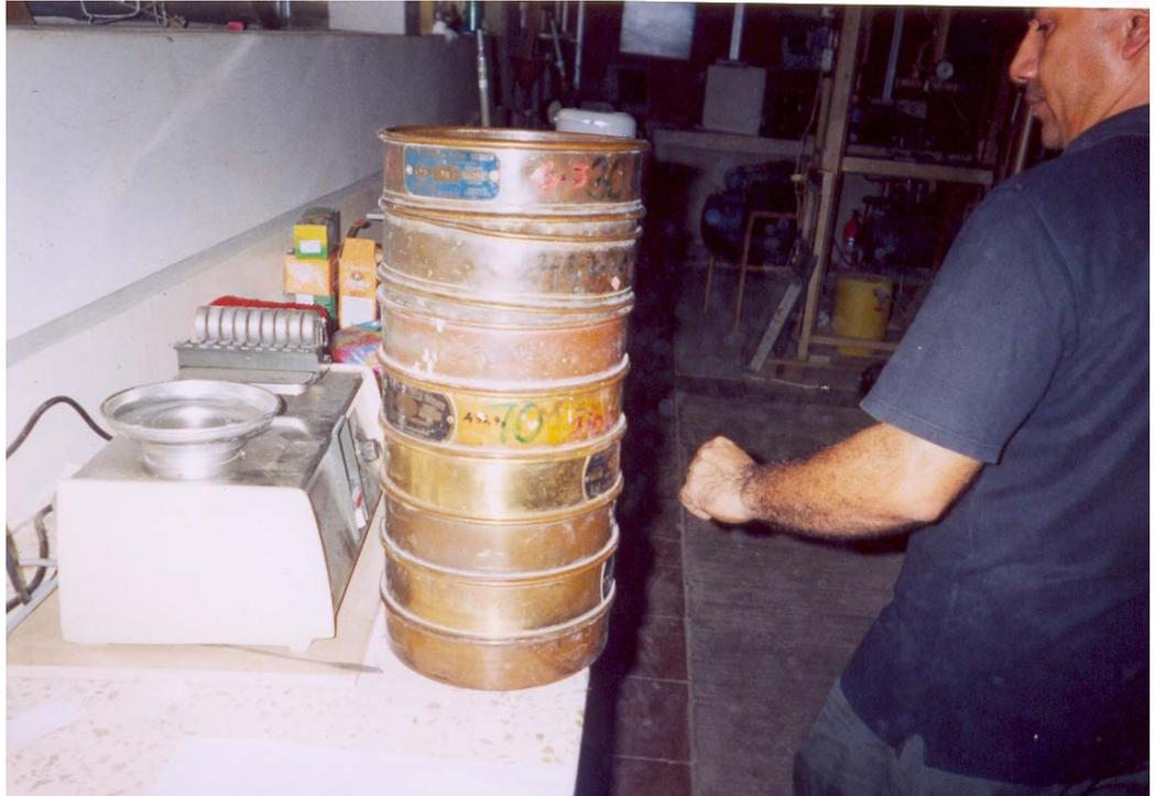
**FIGURA 2.2 ANÁLISIS GRANULOMÉTRICO REALIZADO EN LA FICT.**
