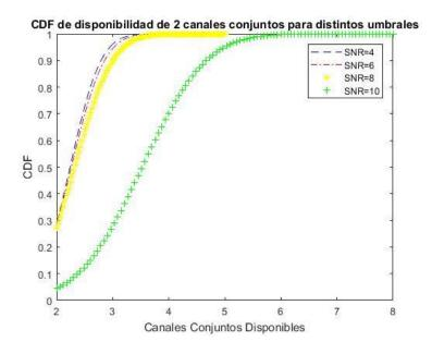
Figura 4.6: CDF de disponibilidad de 2 canales conjuntos para distintas SNR del piso 8,
