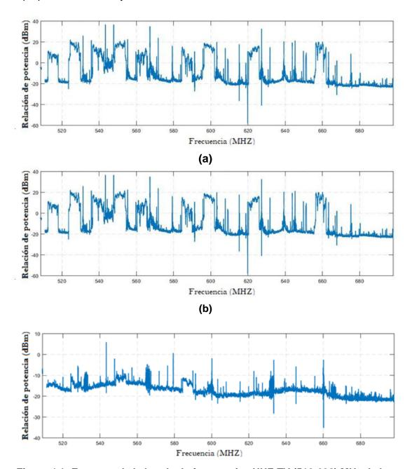
Figura 4.1: Espectro de la banda de frecuencias UHF-TV (512-698) MHz de la (a) piso 8, (b) piso 3 y (c) planta baja.
