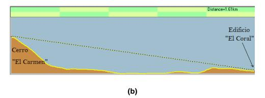
Figura 3.2: Distancia entre los escenarios de transmisión y recepción de señal. (a) Figura obtenida de mapas satelitales, (b) Representación de la línea de vista desde el ámbito únicamente geográfico, sin considerar edificios. Fuente: Radio Mobile, 2017.
