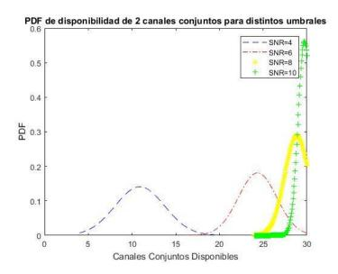
Figura 4.4: PDF de disponibilidad de 2 canales conjuntos para distintas SNR de la planta baja.
