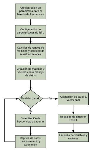
Figura 3.6: Representación del diagrama de flujo de la toma de datos.
