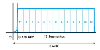
Figura 2.2: Estructura del espectro de señal de Televisión Digital Terrestre.
