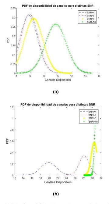
Figura 4.3: PDF de disponibilidad de canales para distintas SNR (a) del piso 8, (b) planta baja.
