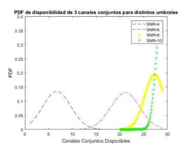
Figura 4.5: PDF de disponibilidad de 3 canales conjuntos para distintas SNR de la planta baja.
