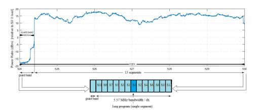
Figura 3.3: Máscara de un canal digital.
