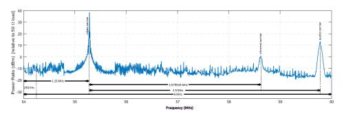
Figura 3.4: Máscara de un canal analógico.
