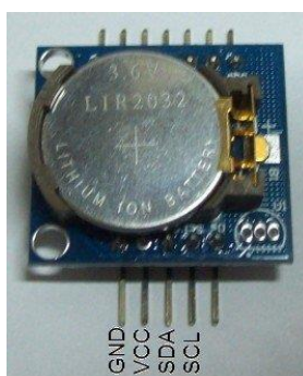
Figura 3.8: Conexión Modulo RTC
