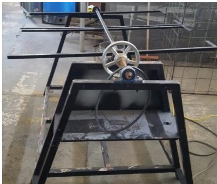
Figura 3.25: Polea y banda de la estructura metálica
