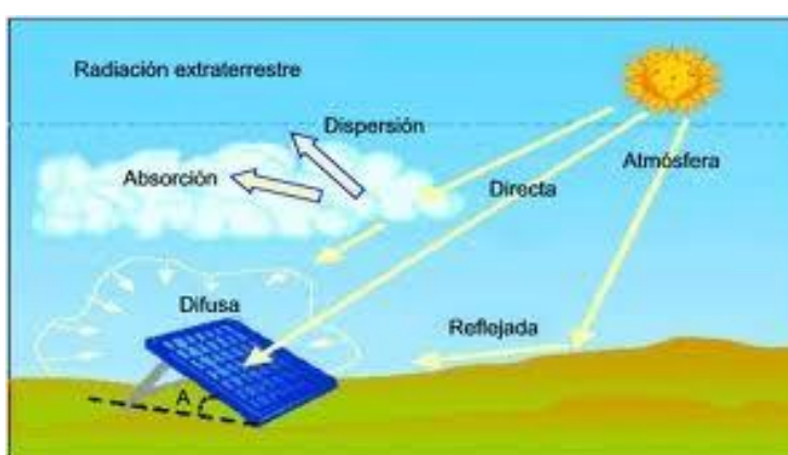
Figura 2.3: Dirección de los rayos solares y posición de un panel fotovoltaico para una máxima captación [4]
