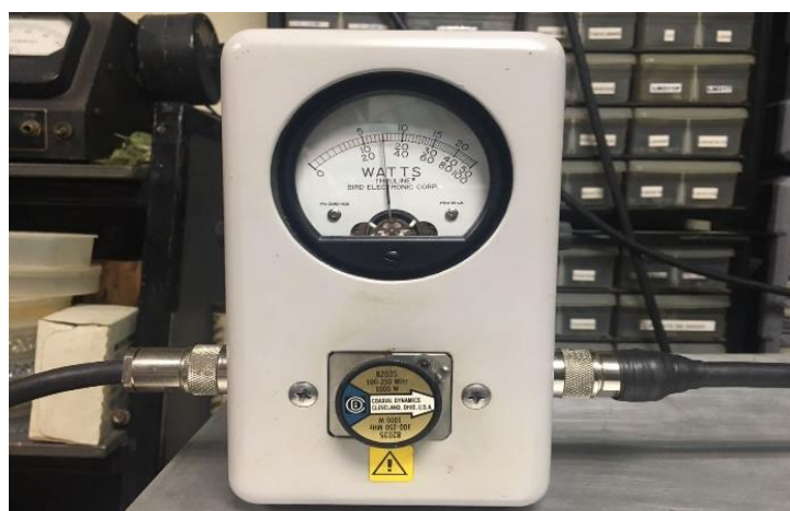
Figura 3.32 Vatímetro marcando una potencia de 300 W
