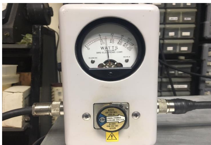
Figura 3.34 Vatímetro con potencia de 298 W
