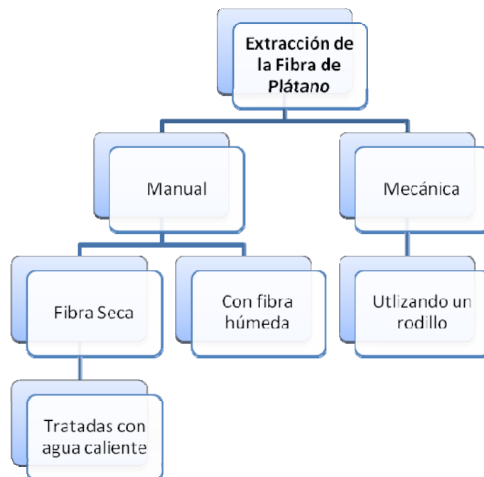
FIGURA 1.2. ESQUEMA DEL MÉTODO DE EXTRACCIÓN DE LA FIBRA
