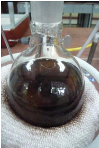
FIGURA 3.12. TRATAMIENTO DE LA FIBRA CON NaOH
