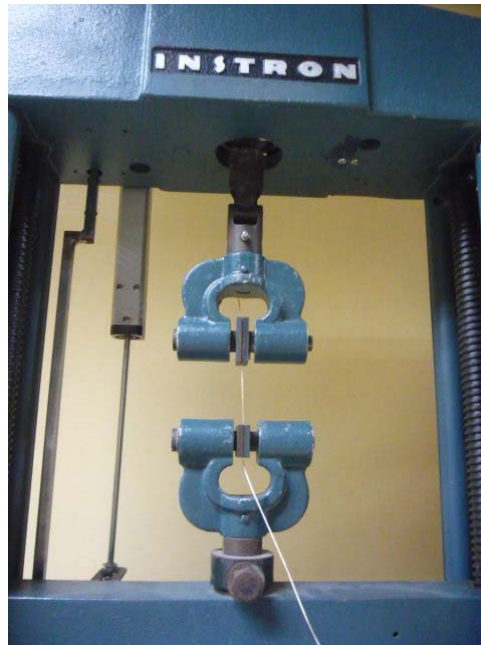
FIGURA 4.3. ANÁLISIS DE FUERZA MÁXIMA A ROTURA POR TRACCIÓN
