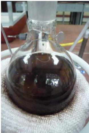
**FIGURA 3.12. TRATAMIENTO DE LA FIBRA CON NaOH**
