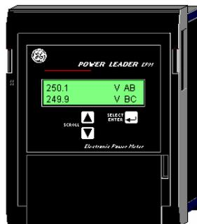
**FIGURA 4.1.**ELECTRONIC POWER METER (PLEPM)
