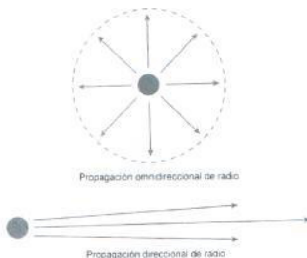
Gráfico 2-20 Tipos de antena y la forma de propagación de la señal[60]
