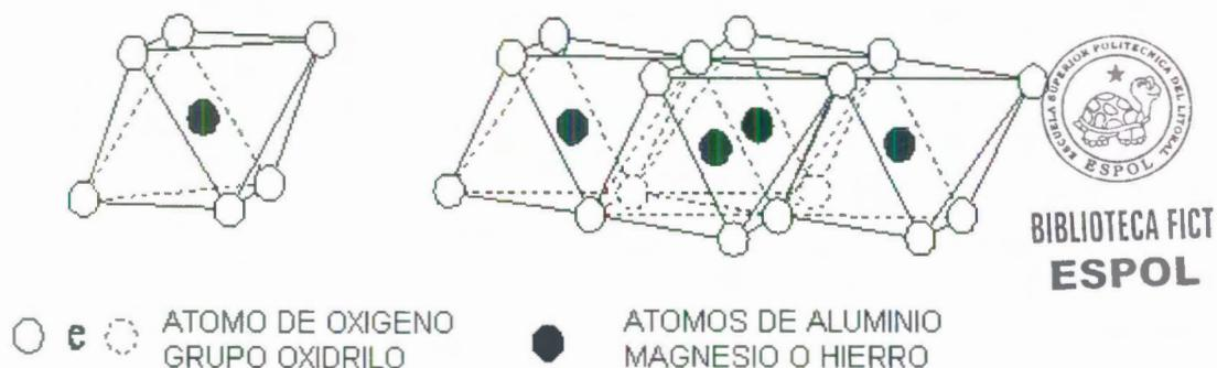
**FIGURA 2.2. DIAGRAMA ESQUEMÁTICO DE (A) LA UNIDAD ESTRUCTURAL OCTAÉDRICA Y (B) ARREGLO DE LAS UNIDADES OCTAÉDRICAS (GRIM, 1953).**
