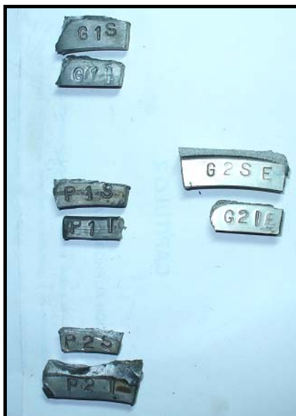
FIGURA 1.9 IDENTIFICACIÓN DE LAS MUESTRAS DE LOS COJINETES
