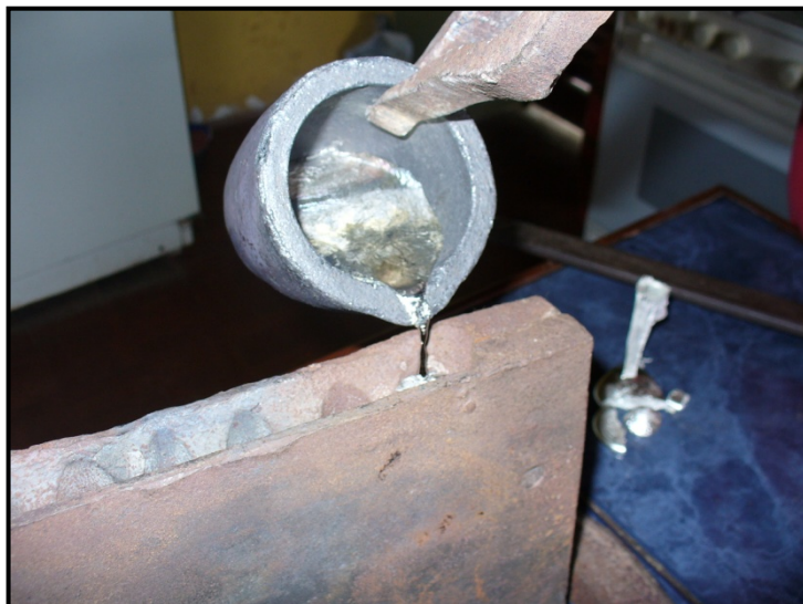
FIGURA 2.3 MOLDE METALICO PARA HACER BARRAS
