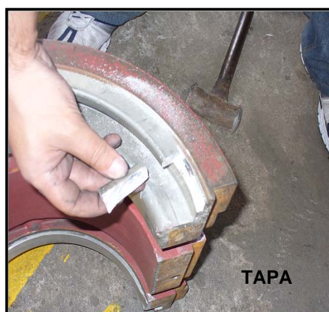
FIGURA 1.8 TOMA DE MUESTRAS DEL LOS COJINETES
