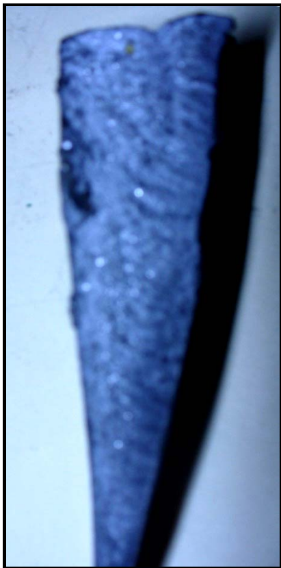
FIGURA 2.14 FRACTURA DE CUÑA EN BASE DE PLOMO
