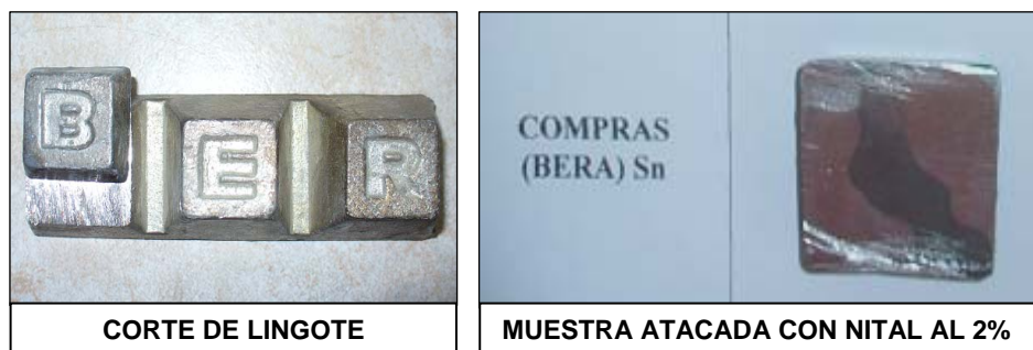
FIGURA 1.18 PROBETAS DE BABBITTS DEL MERCADO, PREPARADAS PARA OBSERVARLAS AL MICROSCOPIO LEITZ
