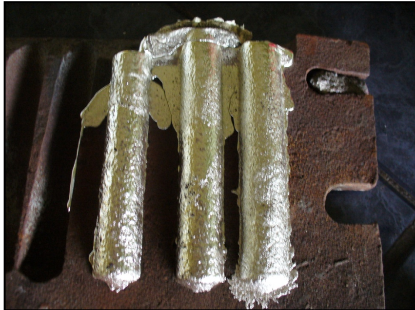
FIGURA 2.4 BARRAS PARA PROBETAS DE ENSAYO DE TRACCIÓN
