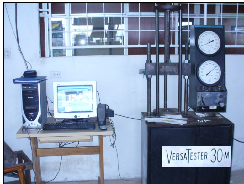
FIGURA 2.7 EQUIPO COMPLETO VERSATESTER 30M ADAPTADO A COMPUTADORA PARA ENSAYO DE PROBETAS EN BASE DE Sn
