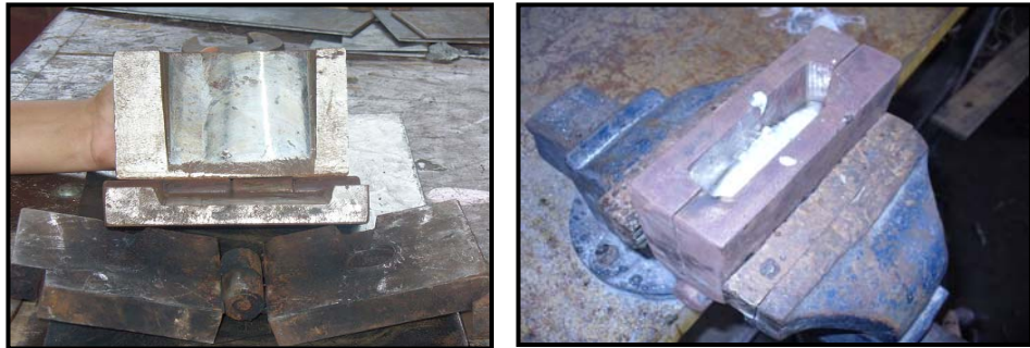
FIGURA 1.22 MOLDE METALICO PARA CUÑA DE TEMPLE
