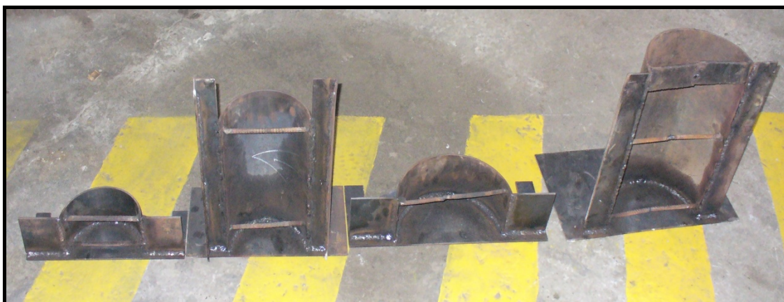
FIGURA 1.30 SEMIMOLDES DE COJINETES VISTA POSTERIOR
