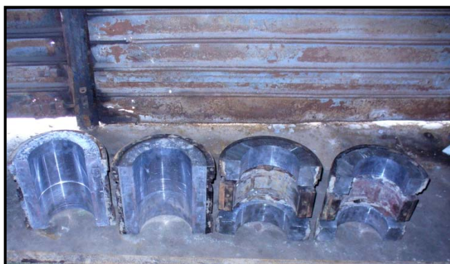
FIGURA 3.5 COJINETES METALIZADOS PREMECANIZADOS
