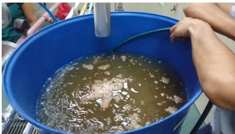
Figura 4-3 Residuos presentes en la recirculación del agua
