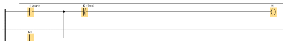
Figura 3-20 Implementación de la primera línea de código en LOGO!Soft Comfort
