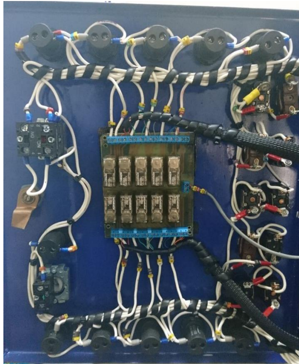
Figura 4-8 Tarjeta selectora de la línea de tubería de presión
