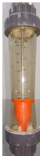
Figura 3-1 Rotámetro de Boya
