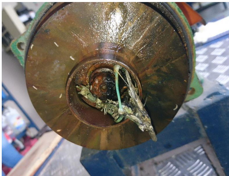
Figura 4-2 Visualización de obstrucción en el impeler
