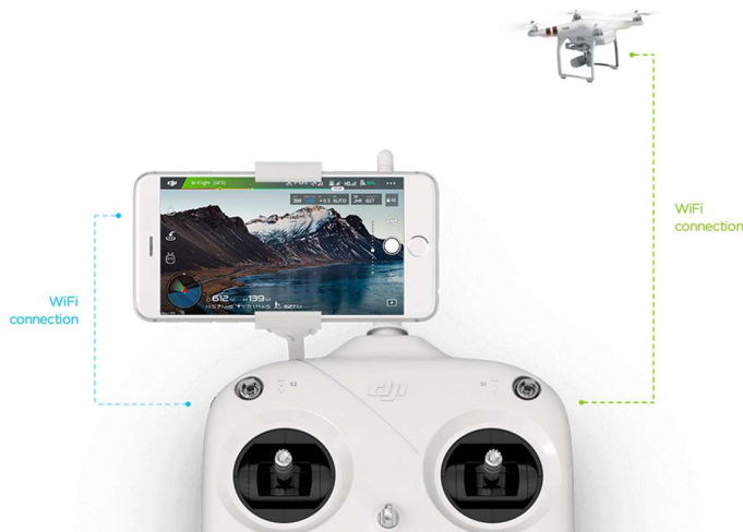
Figura 2.2. Conexión del control remoto con el dron
