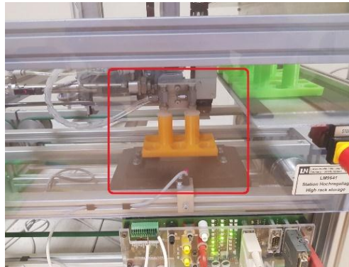
Figura 3.5: Movimiento inicial del brazo para almacenamiento
