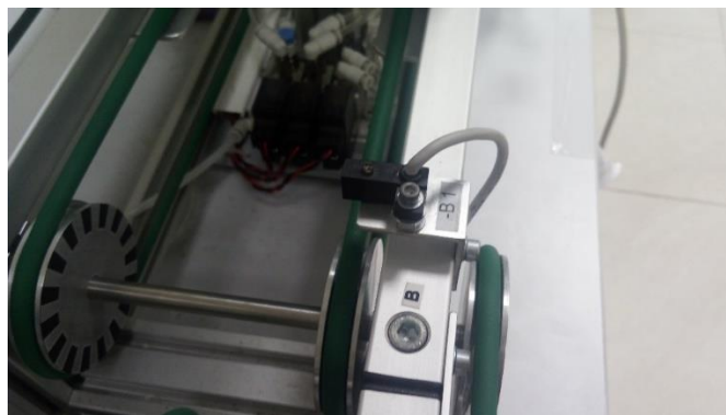
Figura 2.15: Sensor magnético B1, situado a la derecha del IMS10.
