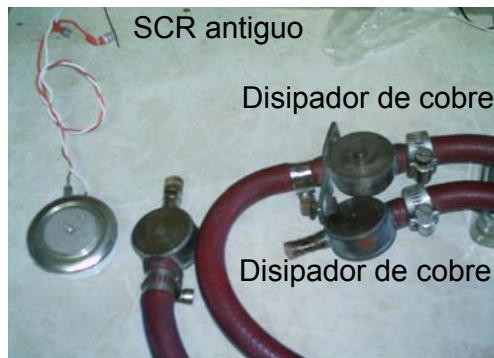
FIGURA. 1.5. MANGUERA, SCR Y DISIPADORES.
