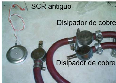
**FIGURA. 1.5. MANGUERA, SCR Y DISIPADORES.**
