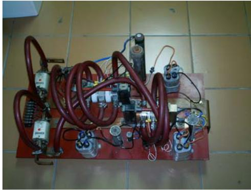
**FIGURA.1.4. INSTALACIÓN DE BLOQUE DE TIRISTORES (SCR).**
