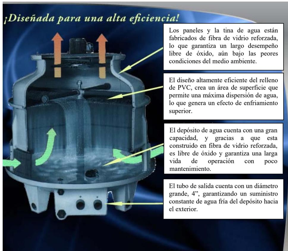
**FIGURA 2.12. CARACTERÍSTICAS DEL DISEÑO DE LA TORRE A USAR, CONTINUACIÓN.**
