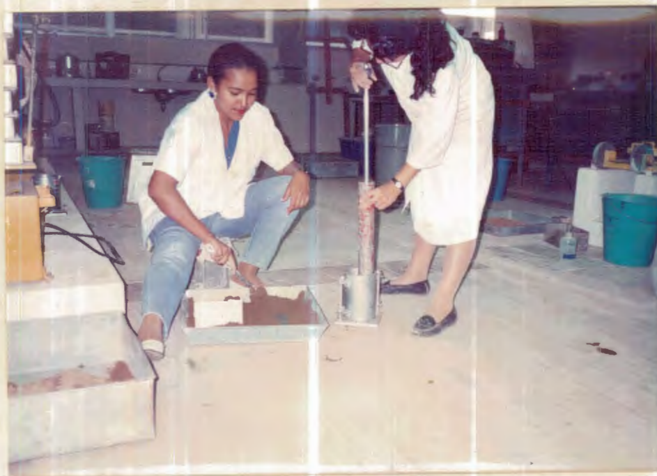
Fotografía #3.- Diferentes contenidos de humedad del ensayo Proctor Stándard con 9% de cemento
