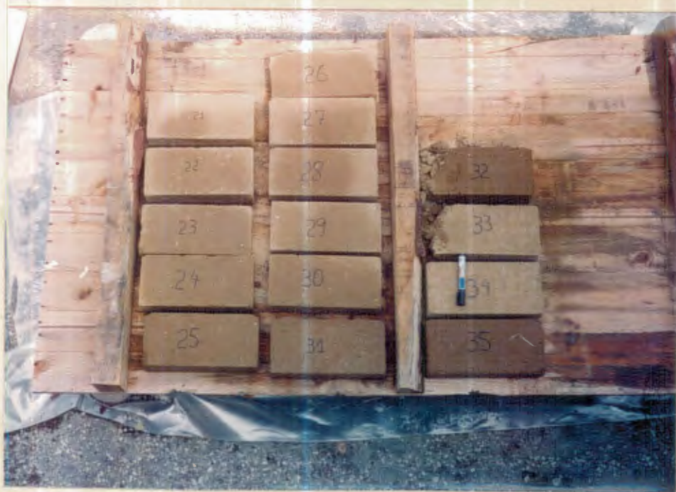
Fotografía #16.- Bloques con diferentes contenidos de cemento y humedad.
