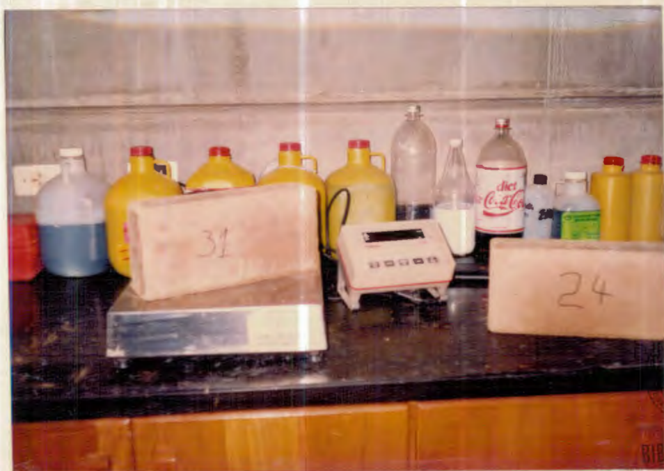
Fotografía #20.- Bloque #31 en la pesa antes de ser ensayado.
