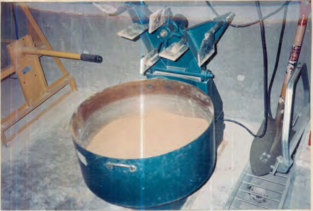
Fotografía #7.- Suelo seco antes de mezclarse
