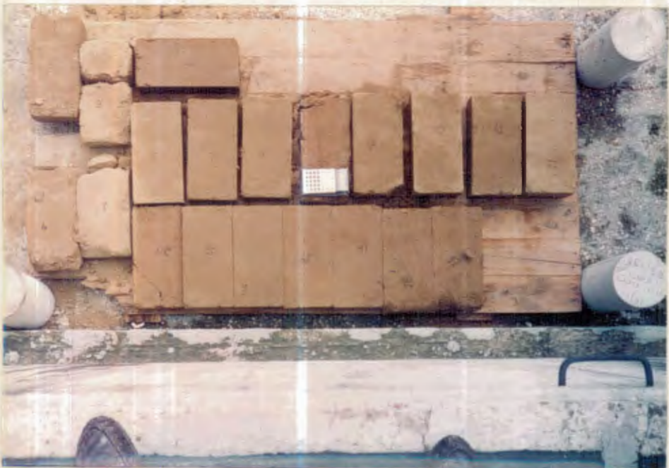
Fotografía #15.- Bloques con 7% de cemento y diferentes contenidos de humedad.
