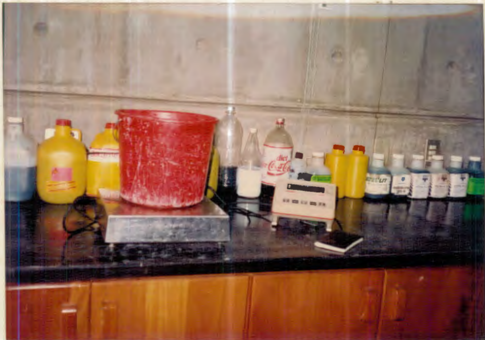
Fotografía #6.- El agua sobre la balanza en el proceso de pesado
