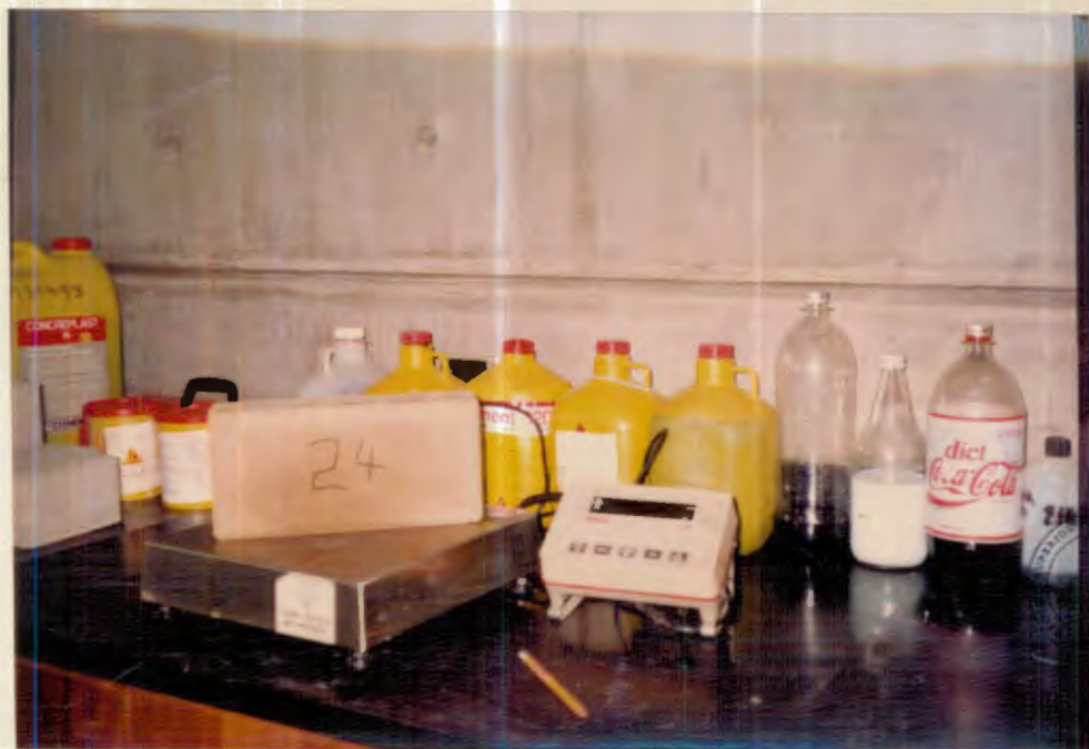
Fotografía #18.- El bloque #24 cuando se pesa antes de ser ensayado.
