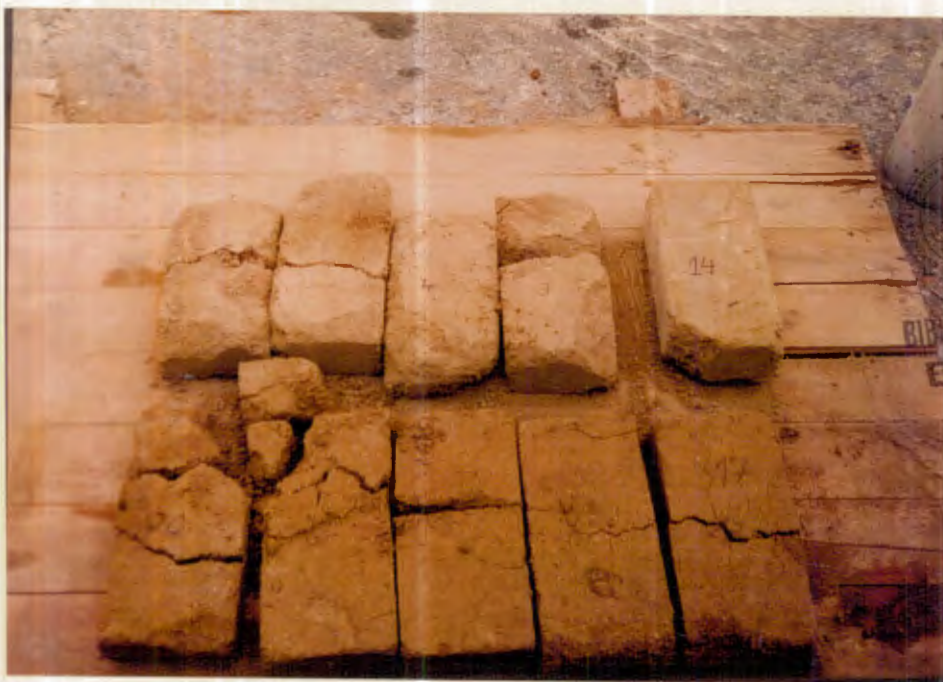
Fotografía #25.- Nótese en la parte superior los bloques con 7% de cemento y 10% de agua (1,2,3 y 4), que no alcanzaron ninguna resistencia y el #14 dañado en las aristas, en comparación con bloques realizados del mismo suelo y sin ningún porcentaje de cemento (totalmente deteriorados), sujetos a las mismas condiciones de lluvias.
