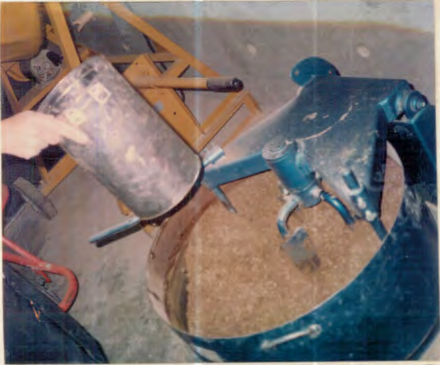
Fotografía #9.- Echándole el agua a la mezcla de suelo - cemento con una regadera.
