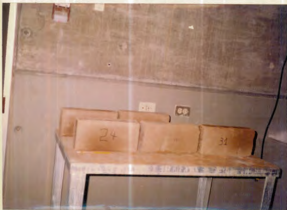
Fotografía #17.- Se observa el acabado de los bloques con diferentes porcentajes de cemento.
