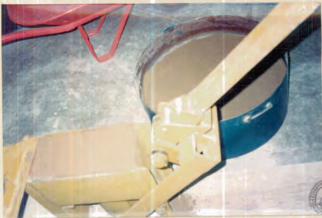
Fotografía #12.- Bloque totalmente compactado.
