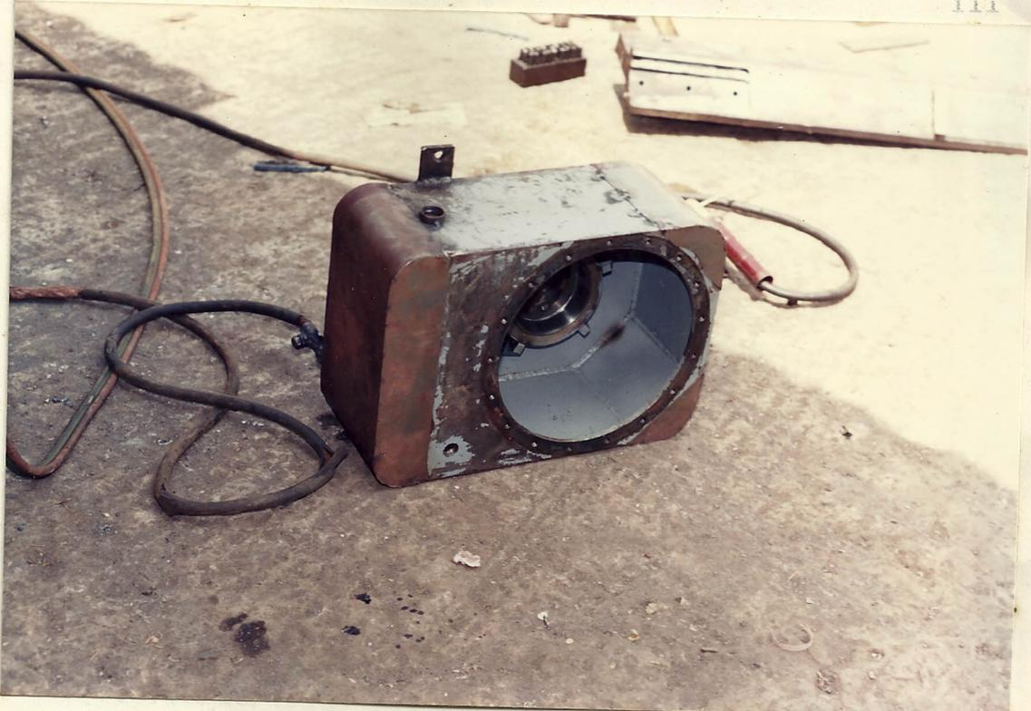
Fig. # 18.- Fresado de guía para cajera fija de tornillo sinfín
